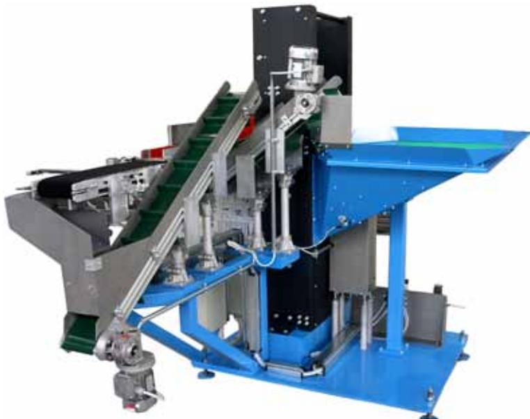
Les pièces en surplus ou mal orientées retombent dans la trémie par l'intermédiaire de la goulotte de récupération ou par un convoyeur de reprise.
